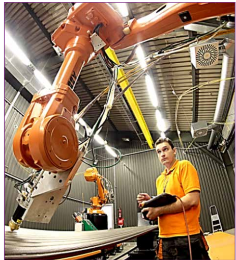
Bild 2: Laserbeschichtung mit einem Industrieroboter
