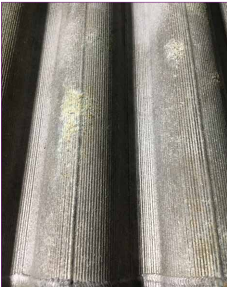
Bild 11: Oberfläche der Testschotte im MK2 nach einem Jahr Betrieb
