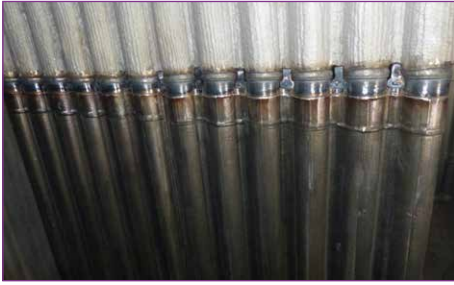
Bild 10: Testschotte mit Highresist-Laserbeschichtung
