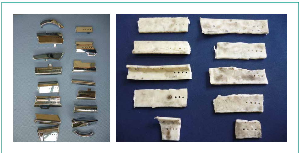
Bild 2: Teile des Versuchsmaterials vor der EHZ (links) und nach 1.000 Impulsen (rechts); die einzelnen Teile sind für eine schnelle und eindeutige Identifizierung mit einem Binärsystem codiert
