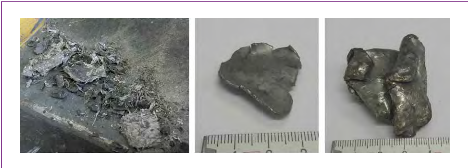
Bild 7: Zerkleinerungsprodukte von links nach rechts: GFK, Vergütungsstahl, mikrolegierter Stahl
