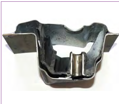
Bild 2: Hybride B-Säule in der Querschnittsdarstellung
