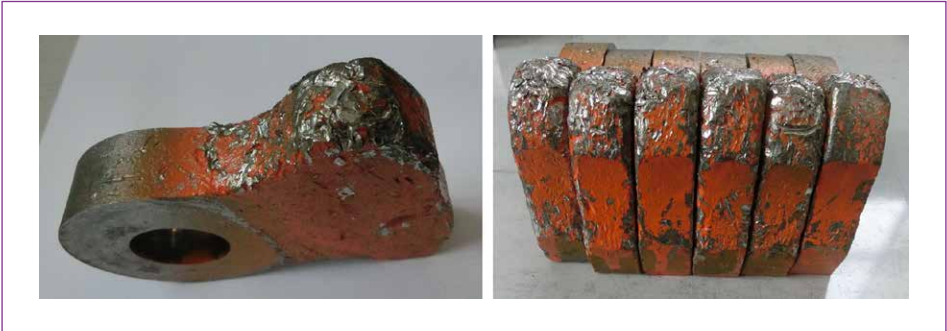
Bild 9: Hämmer der Hammermühle nach dem Versuch V 10
