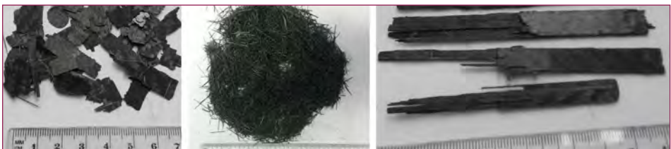
Bild 4: Zerkleinerungsprodukte der Hammermühle aus den CFK-Musterplatten
