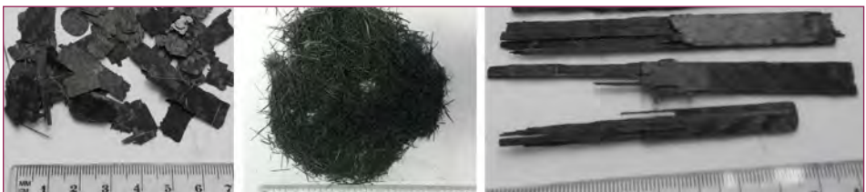
Bild 4: Zerkleinerungsprodukte der Hammermühle aus den CFK-Musterplatten
