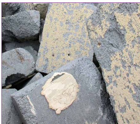
Bild 6: Putz und Klebereste am Dämmstoff
