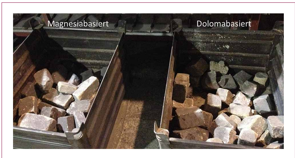
Bild 6: Zwei Produkte der Sortierung mittels LIBS
