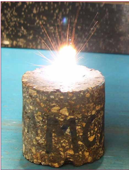
Bild 4: Bohrkern aus Feuerfeststein mit Plasma während der LIBS-Messung
