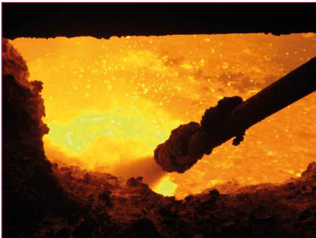
Bild 5: Einblasen von FeSi-Staub durch die Ofentür in die Schlacke
