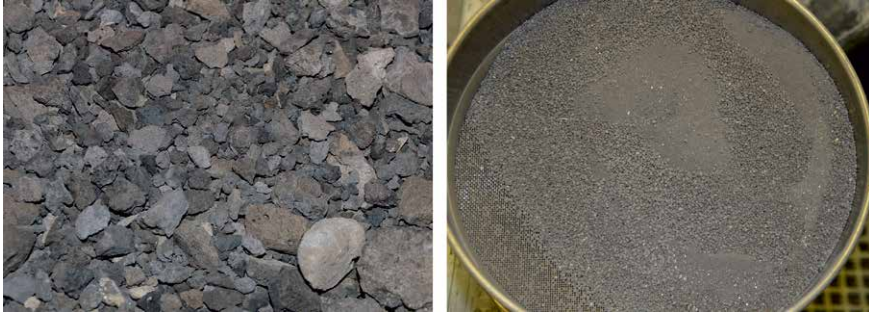
Bild 5: Ausgewählte Probe vor (linkes Bild) und die abgesiebte Fraktion kleiner zwei Millimeter nach der elektrodynamischen Fragmentierung (rechtes Bild)
