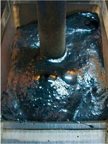
Bild 6: Flotation von Kathodenkohle mit dem Sammler-Schäumer-Reagenz EKO 452 in einer 1 l Flotationszelle (links ohne/rechts mit EKO 452)
