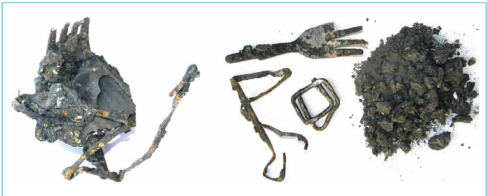
Bild 3: Metallstücke eingeschlossen in Schlacke (links). Die Metallstücke freigelegt und von der Schlacke separiert (rechts)
