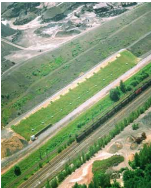
Bild 15: Versuchsziel der großtechnischen Feldversuche: Substitution natürlicher Tonminerale in der mineralischen Dichtung durch gezielt hergestellte Schlackeprodukte aus kalkaluminatischer Gießpfannenschlacke
