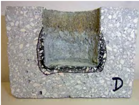
Tiegel D: Innenseite (markierte Infiltrationszone)
