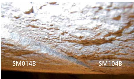
Bild 2: Unterschiedlicher Angriff durch Alkaliangriff an SiC-Betonen
