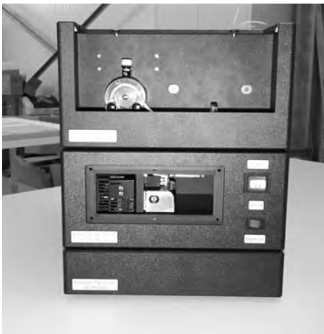
Bild 5: \text{HgCl}_2 -Prüfgasgenerator mit Verdampfer
