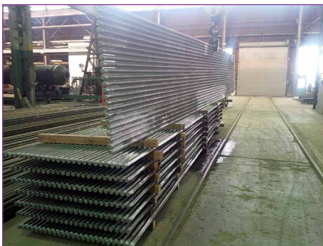
Bild 4: Laserbeschichtungsarbeiten an Kesselrohr-Paneelen
