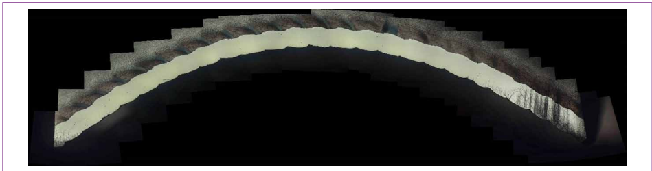
Bild 8: Typische Dicke der Laserbeschichtung (weiß) auf der innen liegenden Seite des Rohrs
