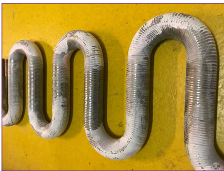
Bild 6: Typische Farbeindringprüfung an gebogenen Rohren in der Produktion
