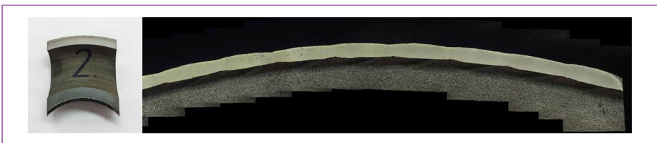
Bild 7: Typische Dicke der Laserbeschichtung (weiß) auf der außen liegenden Seite des Rohrs
