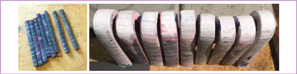
Bild 10: Aus laserbeschichteten Kesselrohren geschnittene Prüfkörper für die Biegeprüfung
