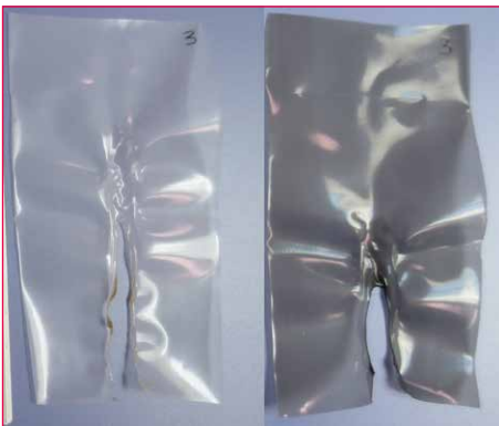
Bild 7: Test des Sekundäradditivblends in einer mit einem bromierten Flammenschutzmittel ausgerüsteten Kunststofffolie; in der Kantenbeflammung zeigt sich anhand der geringeren Eindringtiefe im Vergleich zur Neuware (links) eine bessere Synergiewirkung durch das Sekundäradditiv (rechts)
